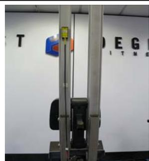
2.1. Расположите длинный кабель под упором для ног и вдоль левой направляющей. Приемник должен располагаться примерно на 1/3 расстояния от длины левой направляющей (внизу вы увидите белую метку, куда нужно приклеить приемник).
