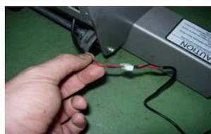
1А. После проверки комплектности, подключите разъем длинного кабеля к разъему от монитора как показано на рисунке
