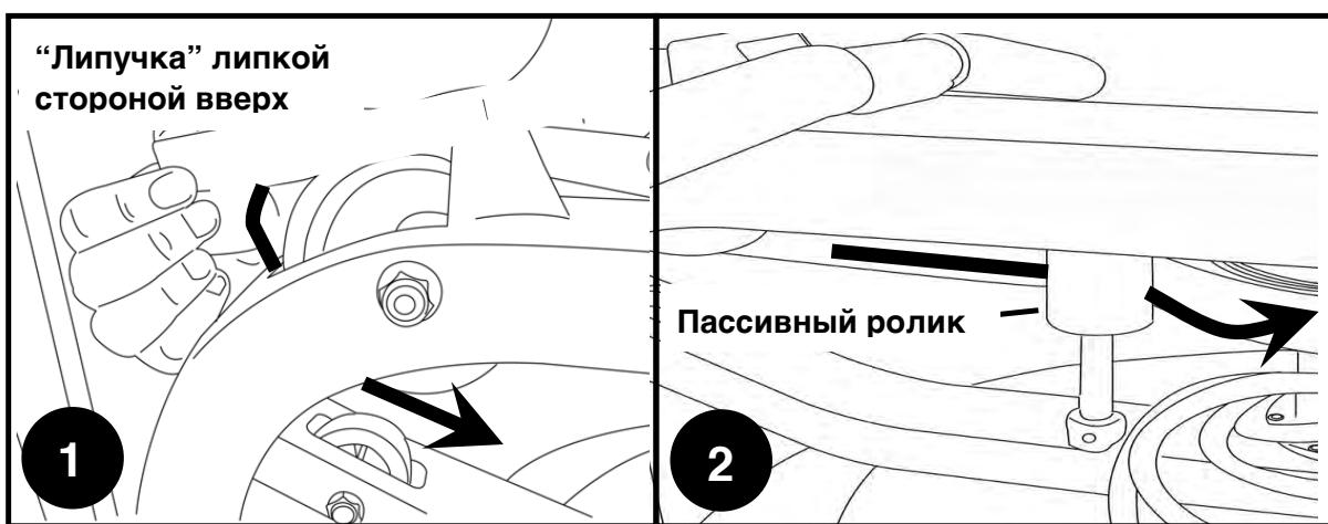
2. Проведите ремень вокруг пассивного ролика, как показано на рисунке. Прикрепите “липучку” ремня к специальной кромке на соединительном ролике.
